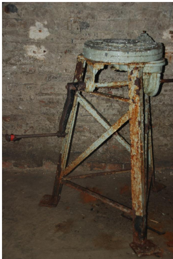
96. fénykép. Kézi levegőztető szerkezet a 156-os teremben.
